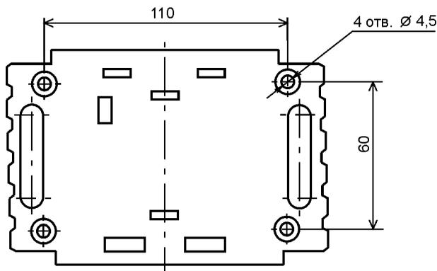
Рисунок 5 – Крепление сетевого контроллера (установочные размеры)
