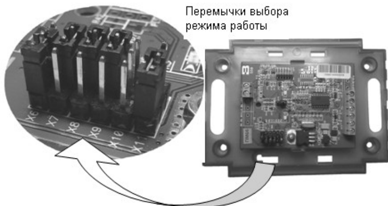
Рисунок 6 – Расположение перемычек на плате адаптера
