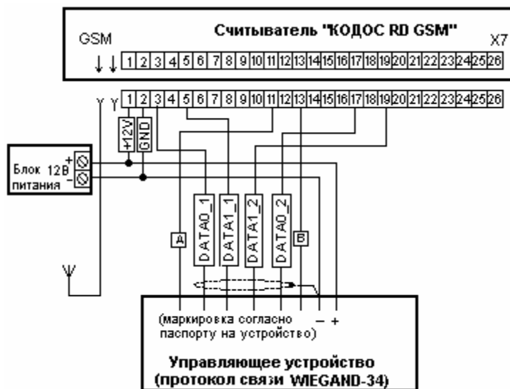
Рисунок 4 – Схема подключения считывателя по протоколу WIEGAND-34 или WIEGAND-26
