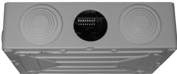
Рисунок 9 – Расположение DIP-переключателей контроллера
