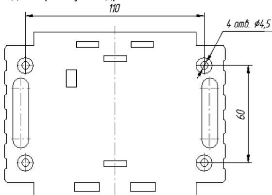
Рисунок 6 - Крепление адресного блока «КОДОС А-09»
