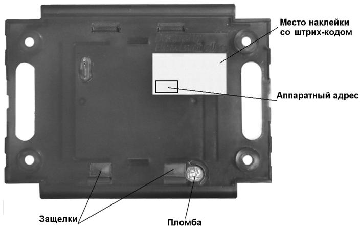
Рисунок 7 – Адресный блок «КОДОС А-09» (обратная сторона)
