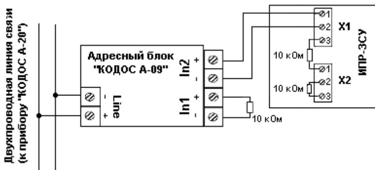
Рисунок 3 – Схемы подключения адресного блока «КОДОС А-09»
