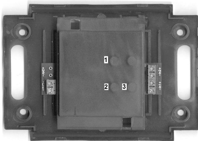
1 – светодиод «Линия»; 2 – светодиод «Питание»; 3 – светодиод «Режим».
