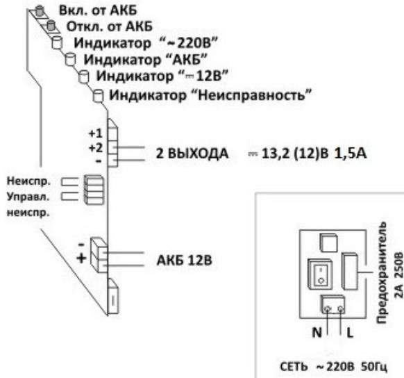
**Рисунок 2 – Подключение контроллера**
