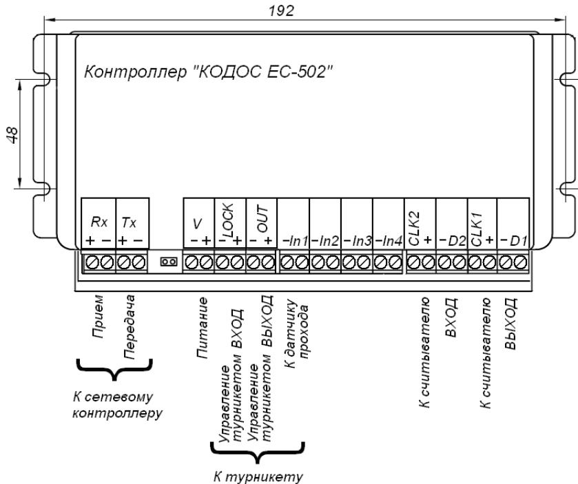
Рисунок 2 – Маркировка и назначение клемм контроллера
