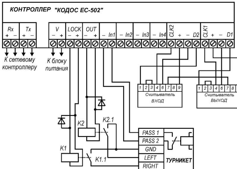
Рисунок 7 – Схема подключения с гальванической развязкой контроллера и турнекета
