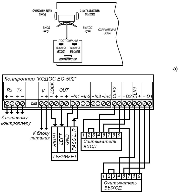
Рисунок 6 – Управление турникетом контроллером с подключенными внешними считывателями:
