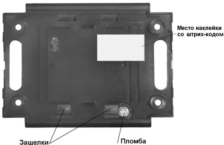
Рисунок 6 – Внешний вид изолятора линии (обратная сторона)
