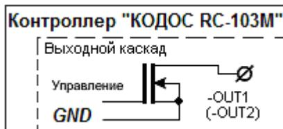
Рисунок 7 – Выходные каскады «-OUT1» и «-OUT2»
