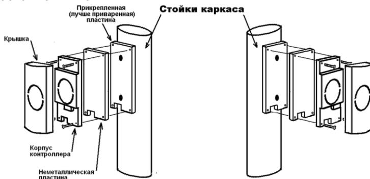
Рисунок 20 – Установка контроллера на общий каркас
