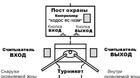
Рисунок 10 – Два внешних считывателя, контроллер в режиме работы с внешними считывателями серии «КОДОС RD»
