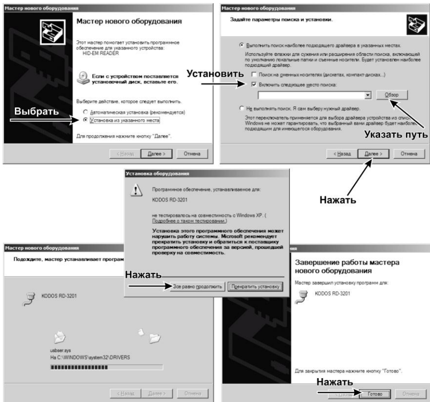
Рисунок 2.7 – Установка драйвера для работы по USB
