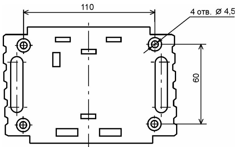
Рисунок 4 - Крепление адресного блока (присоединительные размеры)
