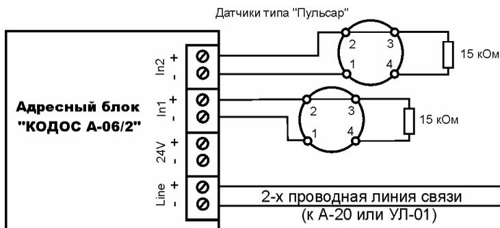
*К одному шлейфу адресного блока может быть подключен только один датчик «Пульсар».*
