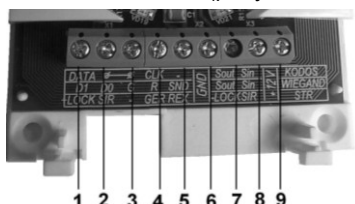
Рисунок 4 – Клеммы считывателя без перемычки
