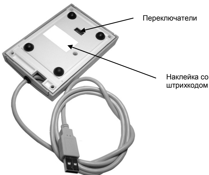
Рисунок 4 – Вид на переключатели с обратной стороны считывателя
