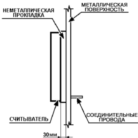
Рисунок 5 – Установка считывателя на металлическую поверхность
