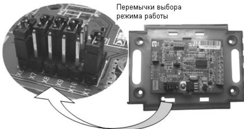
Рисунок 6 – Расположение перемычек на плате адаптера
