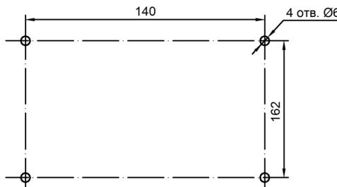
Рисунок 10 – Разметка отверстий для крепления КУ-1
