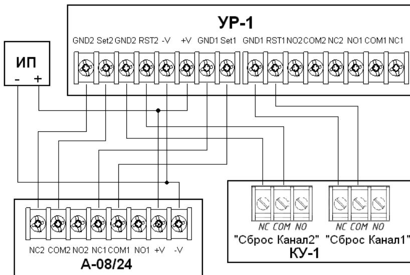
Рисунок 4 – Схема подключения УР-1 и КУ-1 к адресному блоку
