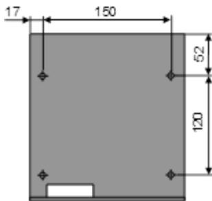
Рисунок 3 – Схем а крепления
