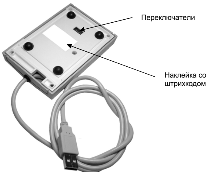
Рисунок 4 – Вид на переключатели с обратной стороны считывателя
